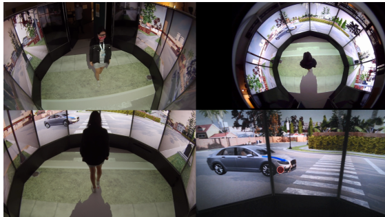
Figure 6. Illustration de l'Immersive Arena où le sujet est face à un passage piéton, devant lequel un VEA s'est arrêté.
